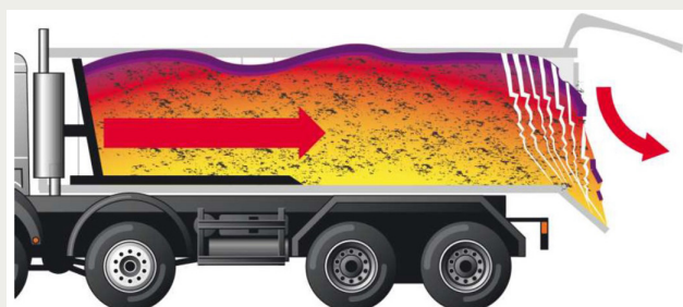
Figur 1. Principskiss av ett Push-off flak.
